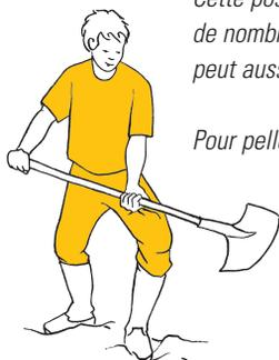
*Pour pelleter, on utilisera des outils adaptés (à long manche), facilitant le mouvement de levier. Pour évacuer la terre avec une pelle, on peut appuyer l'outil sur la partie basse de la cuisse, en pliant le genou.*
